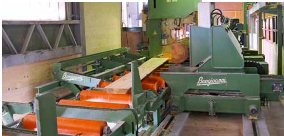
Rund 1,5 bis 2 min braucht die Bandsäge, um einen Stamm (Mitteldurchmesser 500 mm) aufzutrennen – die Model strömen danach zu einer Nachschnittkreissäge mit 3D-Vermessung
